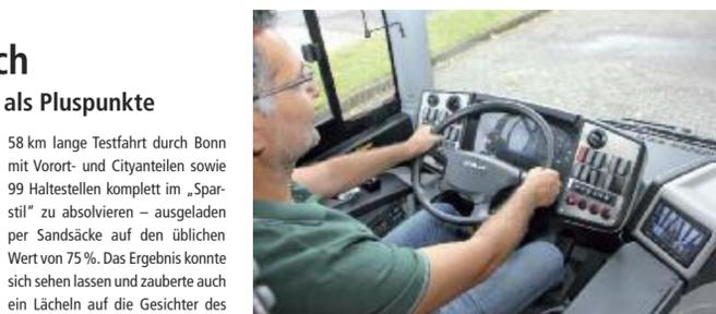
Nicht mehr zeitgemäß: die Armaturen von Actia. Rechts der Monitor zur Überwachung der beiden hinteren Ausstiege. Positiv ist allerdings, dass die Schalter in den verschiedenen Otokar-Modellen gleich sind, was Fahrern und Wartungspersonal die Arbeit vereinfacht.
