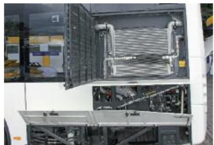
Viele Klappen sorgen linksseitig im Heck für guten Zugang zum seitlich ausklappbaren Wasserkühler und zu den Aggregaten der Abgasnachbehandlung, was die Wartung erleichtert und beschleunigt.
